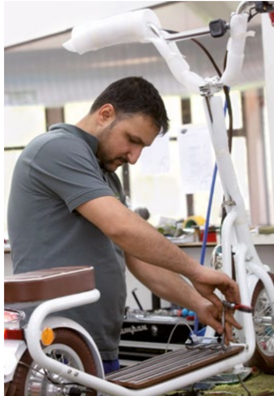
Handarbeit am „1950“: Unter dem Trittbrett des Rollers sitzen die Akkus.
